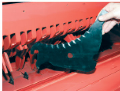
Sustitución de cuchillas Replacement knives
