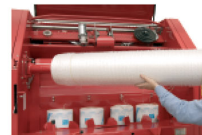
Montaje de la malla Installation net
