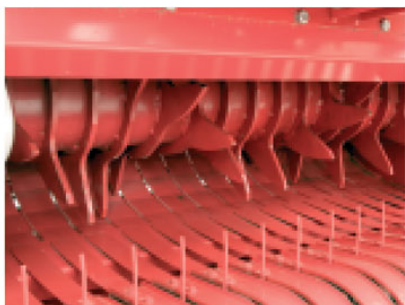
Rotor sin sistema de corte Rotor without cutting system
