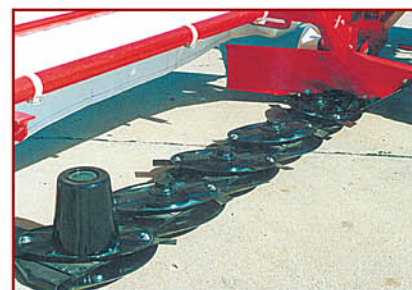
Equipada con 5 discos de alta velocidad de corte de 2950 RPM
