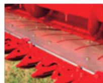
Nueva Geometría en el Sistema Flexible (perfil bajo) de brazo único; logrando una baja pendiente entre los puntones y el piso de la batea, esto permite que la rampa entre la barra de corte y la batea sea prácticamente horizontal, logrando un recorrido del flexible de 14 cm asistido por ballestas; para responder a las mas altas exigencias de cosecha.
