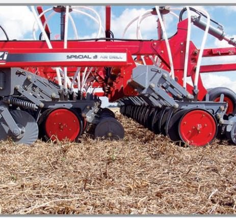
**17.5 cm, 19.1 cm, 21 cm o ...? Ancho de siembra variable es otro de los grandes atributos.** Con Special 3 Air Drill usted no queda limitado a una sola distancia entre líneas de siembra. Los abresueros se ajustan a la barra porta herramientas de diseño triangular a través de un solo tornillo de alta resistencia, permitiendo de esta forma modificar la distancia entre líneas de siembra en un tiempo mínimo y sin quitar los cuerpos de la máquina.
