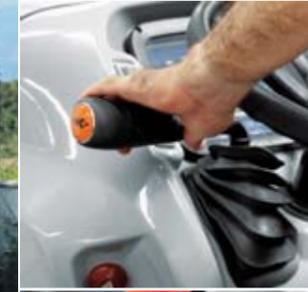
Posee transmisión sincronizada 12x12 estándar, así como una sincronización avance/retroceso, que incrementa la versatilidad de los tractores TDF, mientras que el opcional 20x12 Creeper ofrece velocidades mínimas de hasta 300 m / h, ideal para determinadas aplicaciones.
