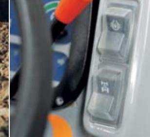
Control estándar electro-hidráulico de la doble tracción y bloqueo de diferencial ubicado en los interruptores.
