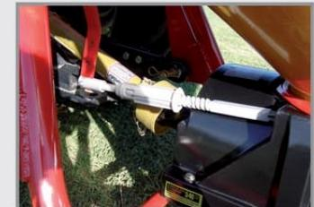
La dosis a aplicar se regula de forma sencilla mediante una empuñadura plástica.
