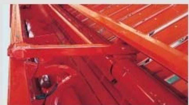
Con el objeto de obtener una regulación simple y rápida de ambos elementos simultáneamente, están montados sobre el mismo soporte sin ningún tipo de vinculación con los laterales del cabezal y su posición se modifica sobre la marcha desde la cabina del operador, mediante cilindros hidráulicos compensados. Gracias a su novedoso sistema de fijación, ambas regulaciones se realizan, además, en un solo movimiento.
