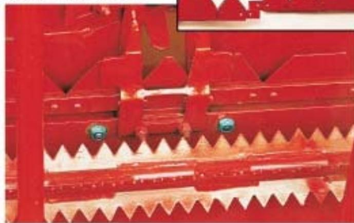
Tres secciones por línea de entrada de plantas le confieren elevada capacidad de corte de tallos. Puntines de amplia garganta permiten, en una sola acción de la cuchilla, cortar tallos de gran diámetro. Un sistema de guías laterales por cada punto incrementan la superficie de apoyo de la cuchilla prolongando la vida útil de las secciones de corte. Fácil y rápido mantenimiento ya que la barra de corte se provee en tramos y las secciones centrales de corte están abulonadas.
