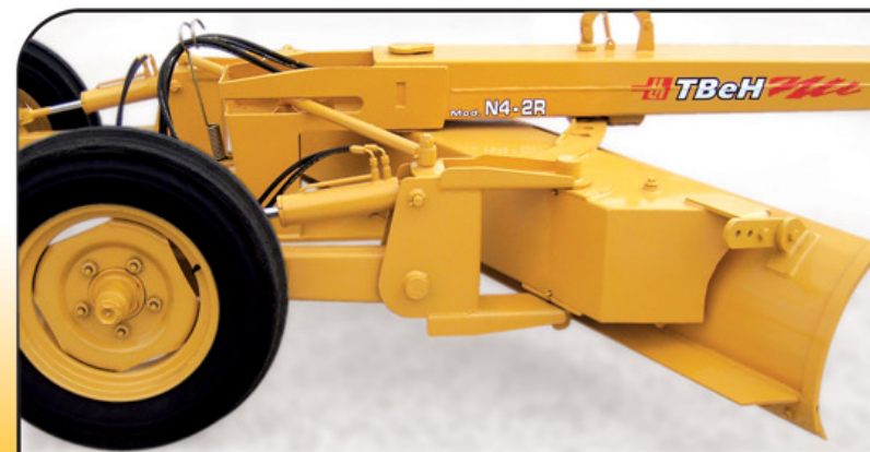
Portavertedera para lastre líquido. Regulación de ataque de vertedera en 3 posiciones.
