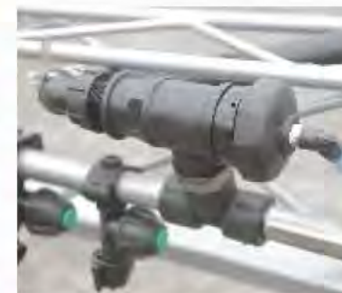
Corte automático de 9 secciones con válvulas neumáticas
