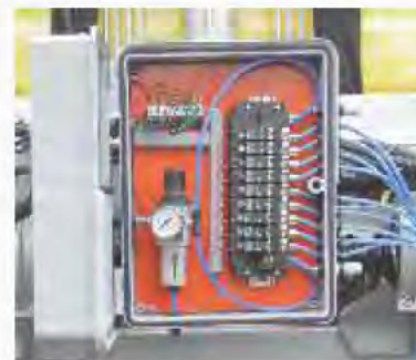
Corte automático de 9 secciones con válvulas neumáticas
