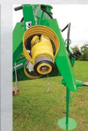
Pie de apoyo Facilitar el enganche del sistema tres puntos del tractor.
