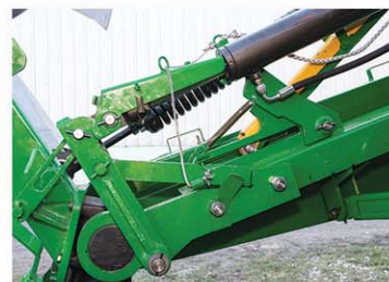
Rise Combined El sistema combinado de elevación permite levantar rápidamente y en forma conjunta la barra de corte y la estructura de la segadora para evitar cualquier obstáculo o para finalizar el tramo de corte.
