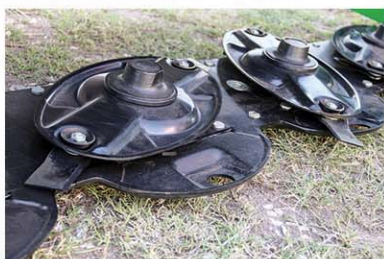
Barra de corte Compuesta por seis discos con pares de cuchillas reversibles.
