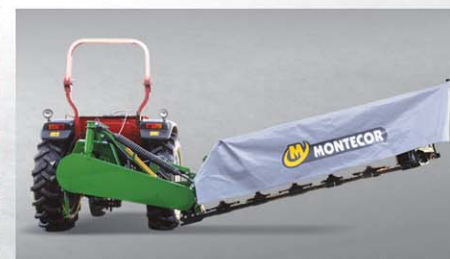
Rise Combined El sistema combinado de elevación permite levantar rápidamente y en forma conjunta la barra de corte y la estructura de la segadora para evitar cualquier obstáculo o para finalizar el tramo de corte.
