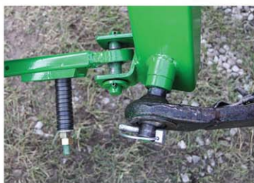
Dispositivo de seguridad Permite la rotación parcial del chasis de la segadora en caso de colisión de la barra de corte con algún obstáculo del terreno.
