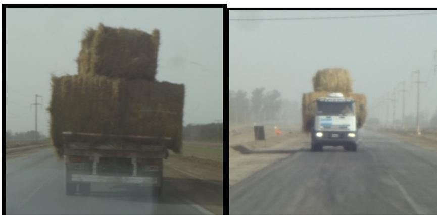
**Figura 2:** Camión transportando rollos de 1,56 m de ancho, con lo cual se supera el ancho máximo permitido.
