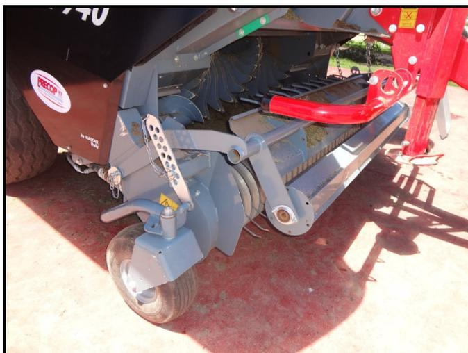
**Figura 7:** Rodillo flotante de pre-compresión del forraje que mejora las condiciones de recolección.
