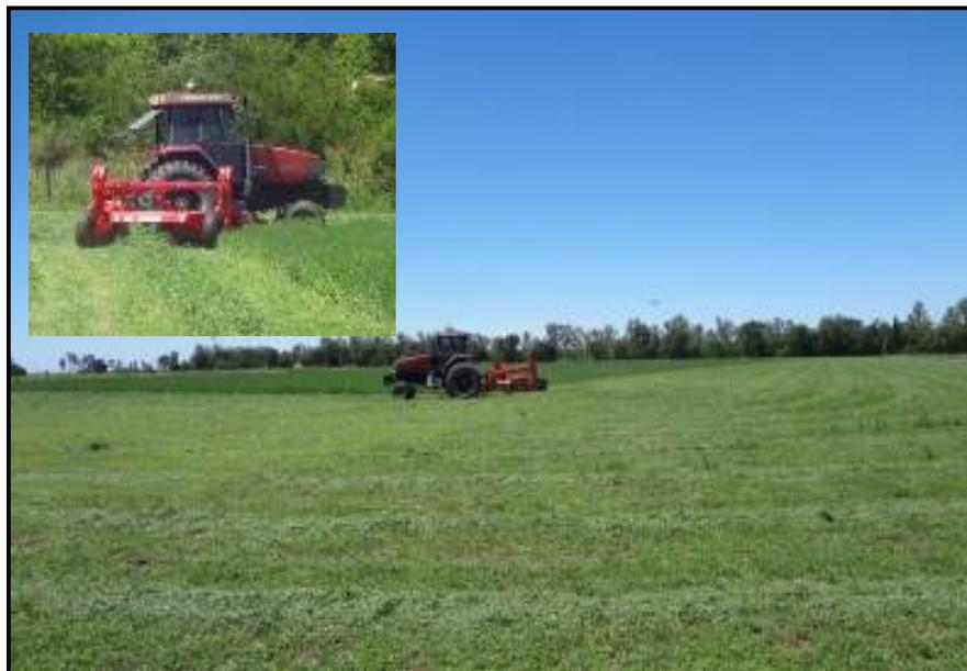
**Figura 4:** Lote cortado en espiral y detalle de giro a 90° sin disminuir la velocidad de avance ni las revoluciones en la toma de potencia del tractor por estar equipada con caja Pivot.
