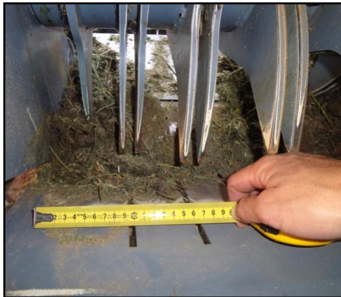
**Figura 20:** Detalle del piso del rotor donde se pueden colocar cuchillas cada 7 cm dejando 11 cm en los laterales.
