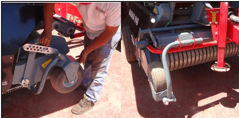
**Figura 10:** La máquina cuenta con ruedas pivotantes de copiado. La altura de estas ruedas es ajustable con un sistema de pernos (Izquierda). A su vez las ruedas pueden ser removidas para disminuir el ancho de transporte a 2,40m (Derecha).
