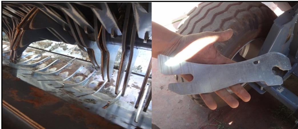
**Figura 22:** Piso del rotor con las aberturas cubiertas con falsas cuchillas para trabajar sin procesar fibra.
