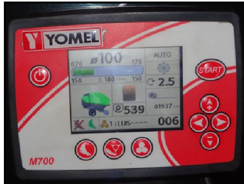
**Figura 17:** Pantalla del monitor cuando la máquina está en pleno funcionamiento llenando la cámara procesando fibra con 7 cuchillas.
