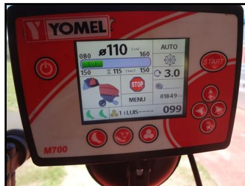
**Figura 16:** Pantalla del monitor cuando la máquina está detenida.
