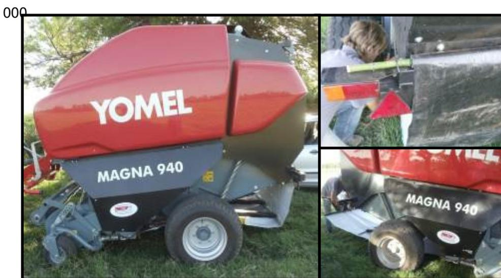
**Figura 28:** detalle de la bandeja recolectora de pérdidas en cámara de compactación
