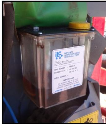
**Figura 26:** Depósito de aceite del sistema de lubricación automático.
