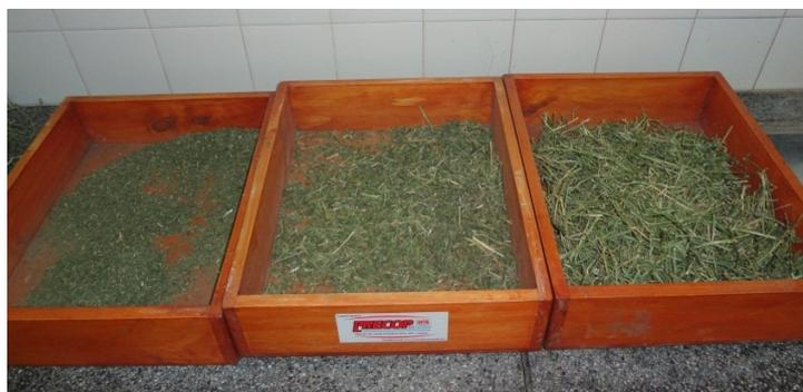
**Figura 29:** Separador de partículas tipo Penn State.
