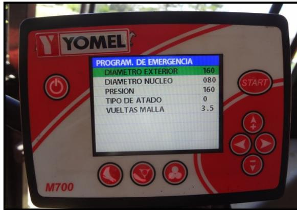
**Figura 12:** Configuración de distintos parámetros desde el monitor
