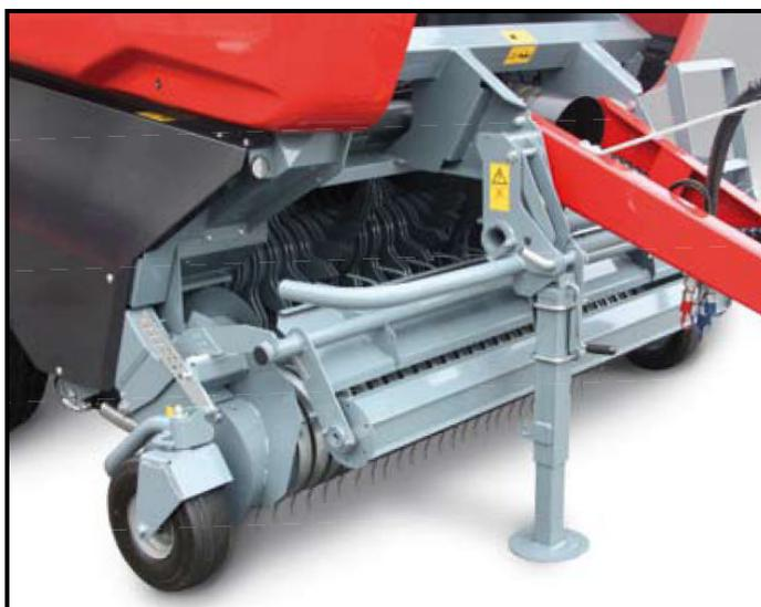
**Figura 8:** Recolector más ancho que la cámara de compactación.
