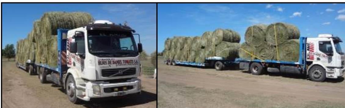
**Figura 1:** Rollos de 1,20 metros transportados en camión de 2,40 metros de ancho (entran dos rollos).
