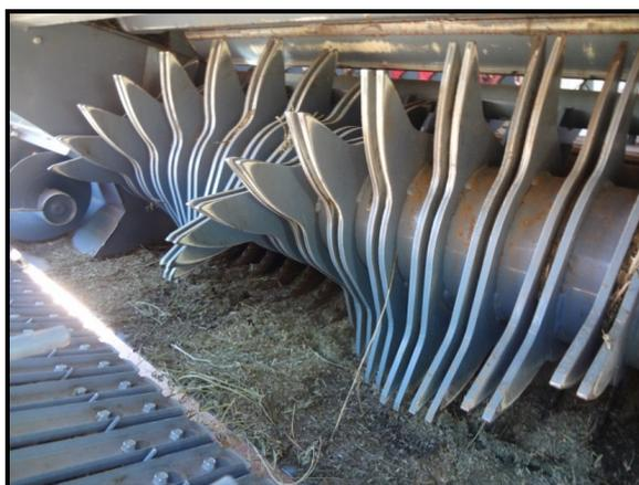
**Figura 18:** Detalle del rotor alimentador compuesto por 14 pares de estrellas de distribución helicoidal.
