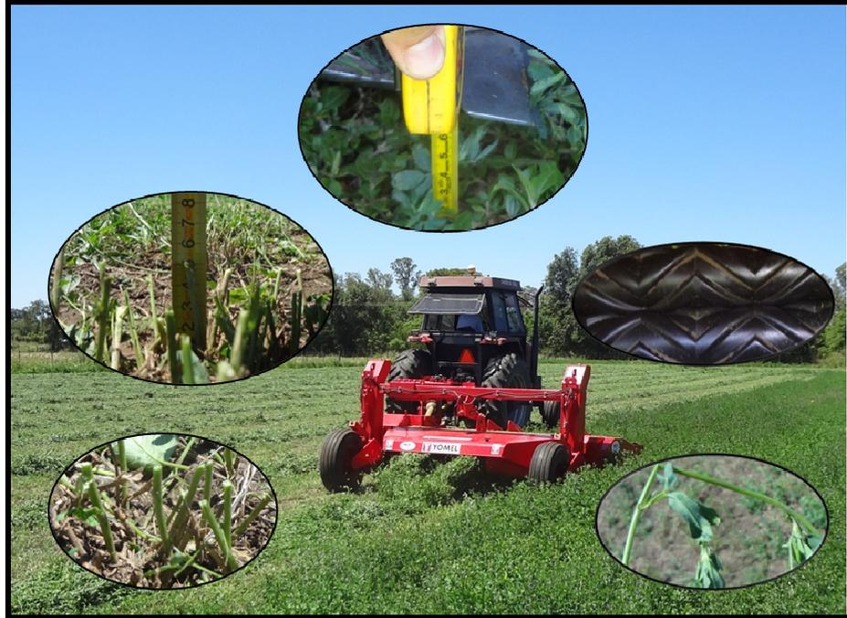
**Figura 3:** Detalles del corte con la segadora/acondicionadora Yomel Moscato 3370. Observar la calidad del corte neto (sin producir deshilachado de los tallos) y el accionar de los rodillos acondicionadores.
