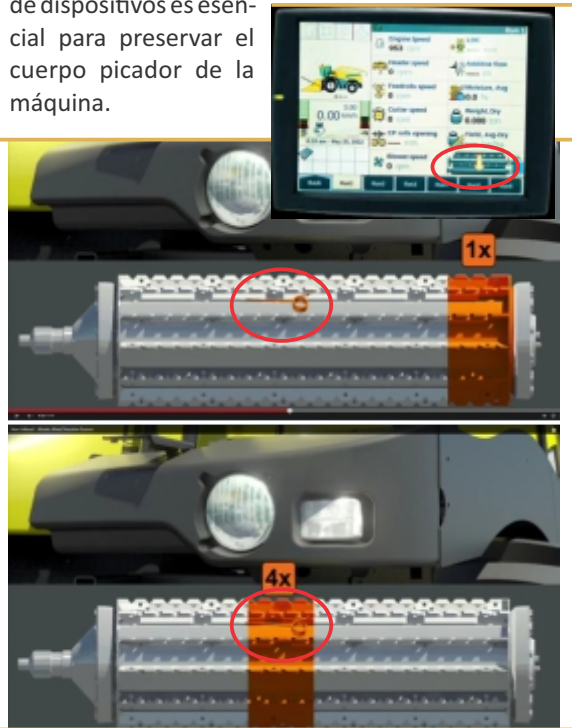
Figura 8: Indicador de la sección en la que fue detectado el cuerpo metálico.
