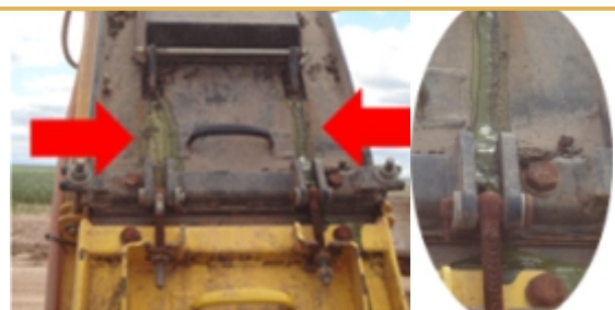
Figura 28: Correado de jugo sobre la jirafa de la picadora al trabajar con un material con 30% MS (lote B4)
