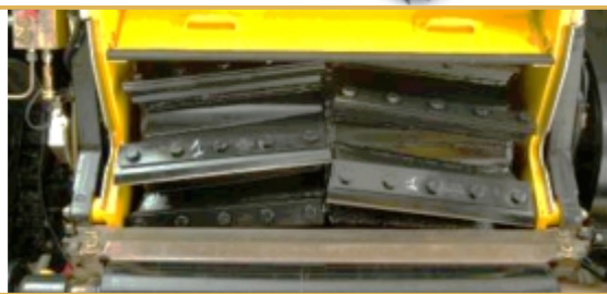
Figura 9: Detalle de rotor picador con distinto número de cuchillas.
