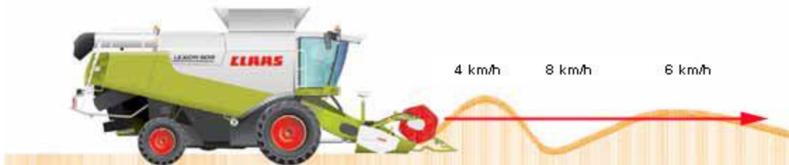
FIGURA 4: Explicación gráfica de cómo varía la velocidad en función del flujo de cultivo utilizando un sistema RF (Claas, 2009).
