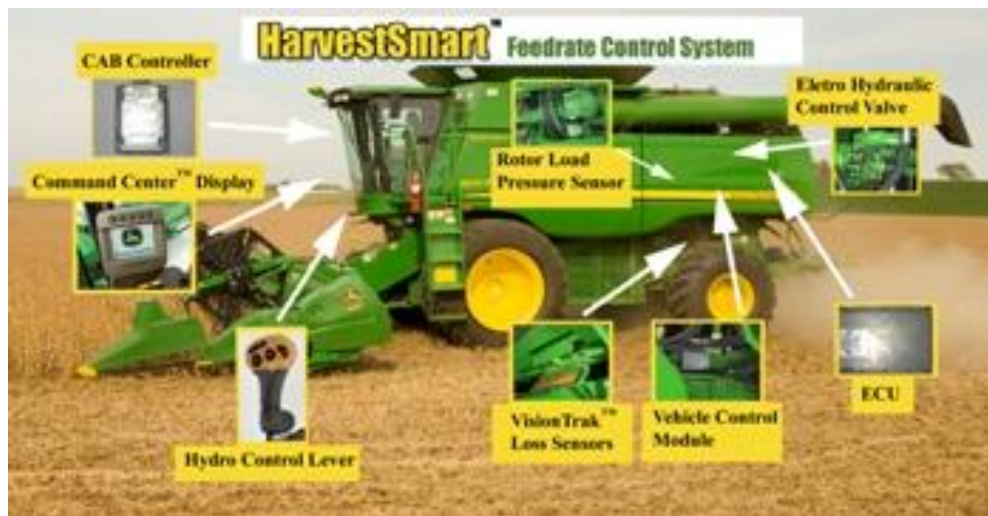
FIGURA 5: Componentes del sistema Harvest Smart (John Deere, 2009).
