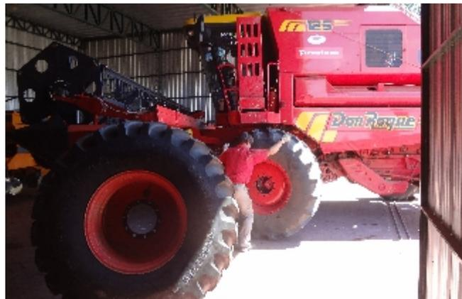
Figura 9: Reemplazo de neumáticos Firestone 650/75 R32 diseño Radial All Traction Deep Tread R-1W .por Firestone 24.5-32, diseño SAT 23° R-1.
