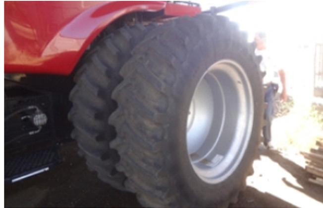
**Figura 22:** Cosechadora equipada con neumáticos duales. Para realizar el traslado se pueden desmontar las ruedas externas.
