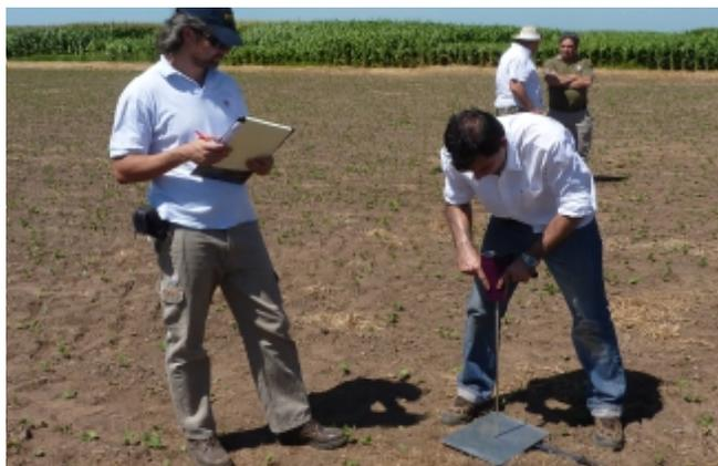
Figura 11: Medición de resistencia a la penetración sobre huella por índice de cono
