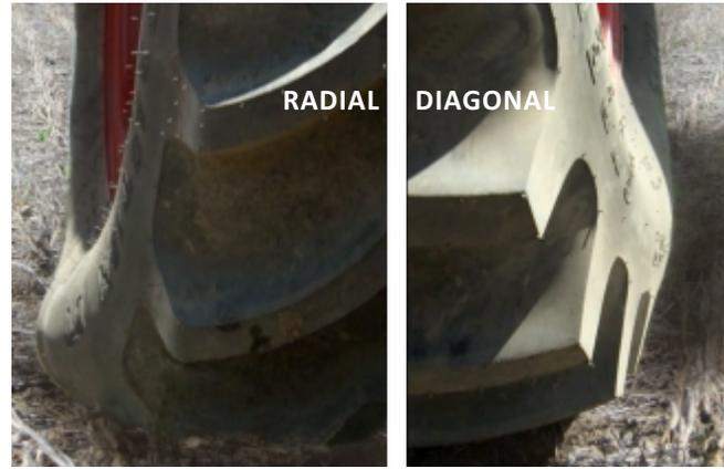
**Figura 17:** Flexibilidad de carcasa de un neumático radial vs uno convencional, (mayor área de contacto y menor presión ejercida sobre el suelo).
