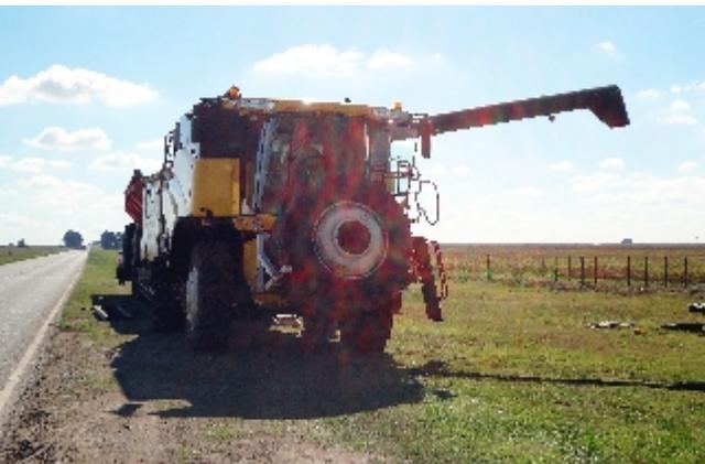
**Figura 20:** Equipar a la máquina con neumáticos duales brinda una mayor flexibilidad a la hora del traslado.
