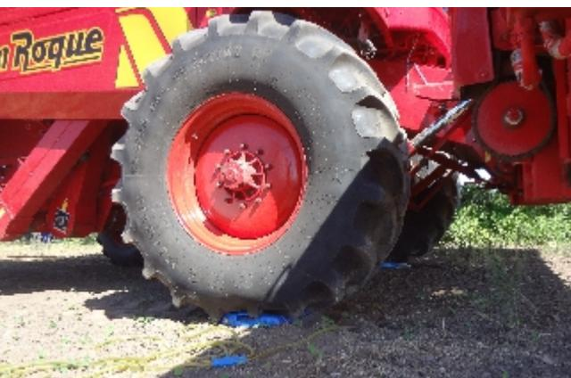
Figura 10: Medición de peso de cosechadora DR 125M con balanza portátil Vesta.
