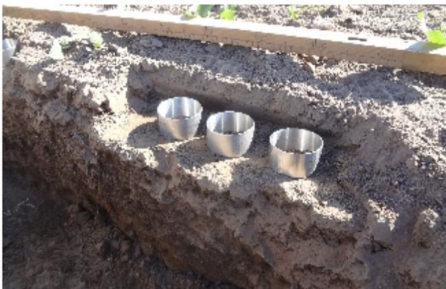
Figura 12: cilindros estandarizados para medición de densidad aparente.
