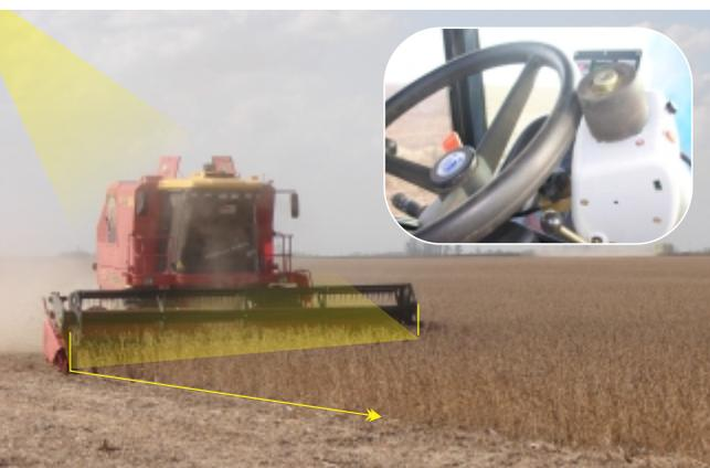
**Figura 18:** Cosechadora guiada con auto-guía trabajando con el cabezal a pleno ancho
