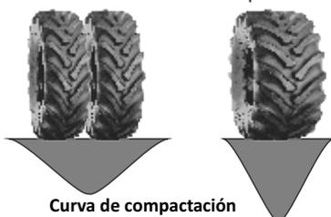
**Figura 21:** Los neumáticos duales, respecto a los simples, disminuyen la compactación en profundidad pero incrementan la superficie compactada.
