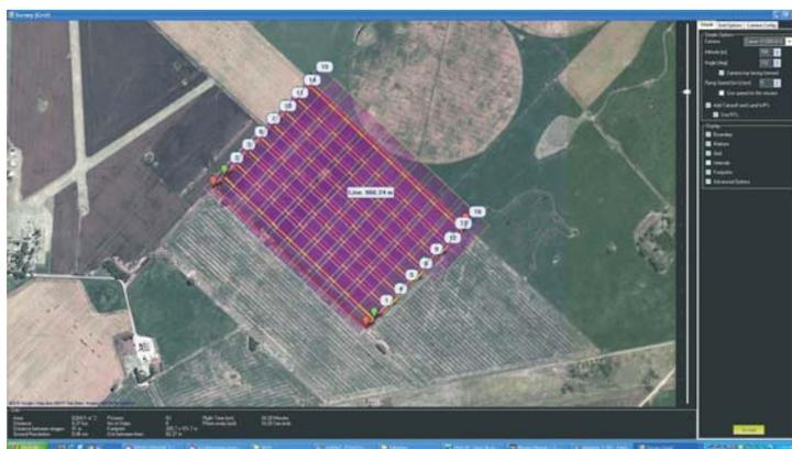
Figura 1- Configuración del solapamiento de imágenes
