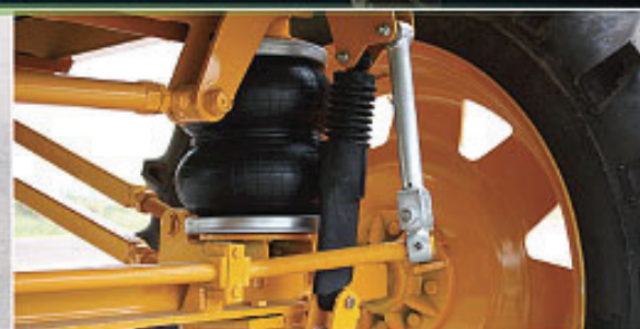
Rodado Simple con suspensión neumática, amortiguadores y barra estabilizadora
