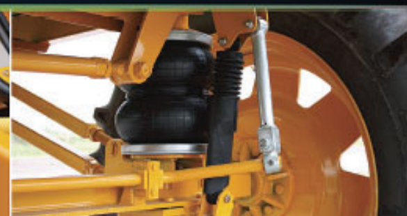
Suspensión neumática, amortiguadores y barra estabilizadora.
