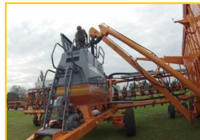
Disposición del carro semillero/fertilizante para la carga de las tolvas.
