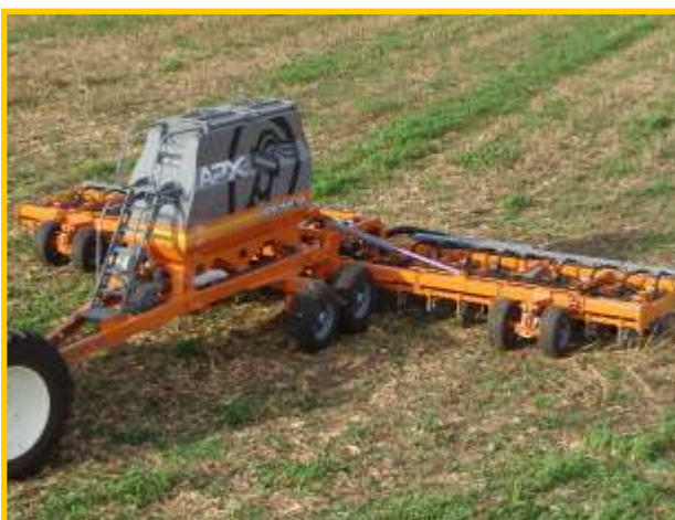
Disposición del carro semillero/fertilizante para la carga de las tolvas.
