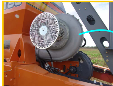
Turbina de soplado para semilla y fertilizante con accionamiento hidráulico desde el tractor.
