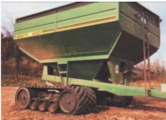
**Figura 26.** Banda de caucho de bajo perfil, alta flotabilidad, bajas huellas, excesivo costo y poca adaptación para el barro.
