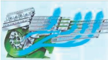
**Figura 12.** Sistema de limpieza de nueva generación. Se observan las desviaciones en el recorrido del aire, la mayor superficie de limpieza al utilizar una mesa de preparación con aire y cribas y la uniformidad de entrega del aire por la turbina.
