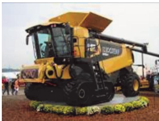
**Figura 15.** Cosechadora con equipamiento de banda de caucho de perfil bajo. Buena prestación para transitar por suelo húmedo evitando huella, pero baja adaptación para funcionar en el barro. Con ello se obtiene buena transitabilidad, gran estabilidad de la cosechadora, mejor adaptación para moverse sobre caminos que las orugas de acero y mayor velocidad máxima de traslado.
