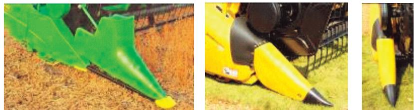
**Figura 50.** *Puntones laterales de materiales plásticos con nuevo diseño. Nótese el diseño ultraliviano de los mismos, como así también sus bajas dimensiones.*
