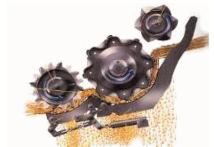
**Figura 10.** Sistema de trilla con acelerador y colado de grano progresivo.
