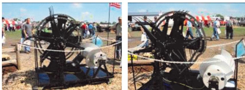
**Figuras 37.** Detalle del Molinete orbital “Orbit Reel” de origen americano. A = Detalle de la forma de entrada y salida del diente, y B = Modificación del excéntrico o guía del diente para permitir acercarse más al molinete al cabezal, eliminando la zona de acumulación. HCC, Inc. – [www.hccincorporated.com](http://www.hccincorporated.com)
