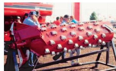
**Figura 17.** Rotor de la cosechadora axial.
