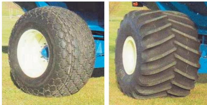
**Figura 28.** Der.: Neumático radial de baja agresión al suelo, dibujo tipo rombo. Ideal para acoplados tolvas. Izq.: Detalle de neumático radial de alta flotabilidad, gran ancho y largo con pisada plana de su banda de rodamiento.
