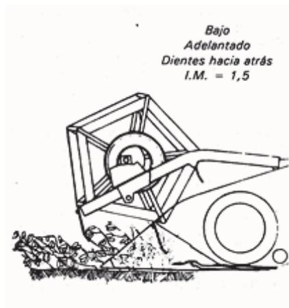
**Figura 26.** Regulación del molinete para cultivos volcados.
