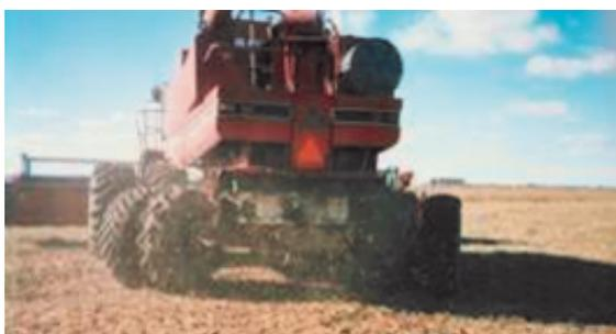
**Figura 21.** Cosechadora 8x4, vista trasera de un equipamiento ideal para transitar en situaciones extremas. Duales traseras, internas tipo pala, y delantera idem. Flotabilidad y alta tracción. Cosechadora de 280 CV, el equipamiento ideal.
