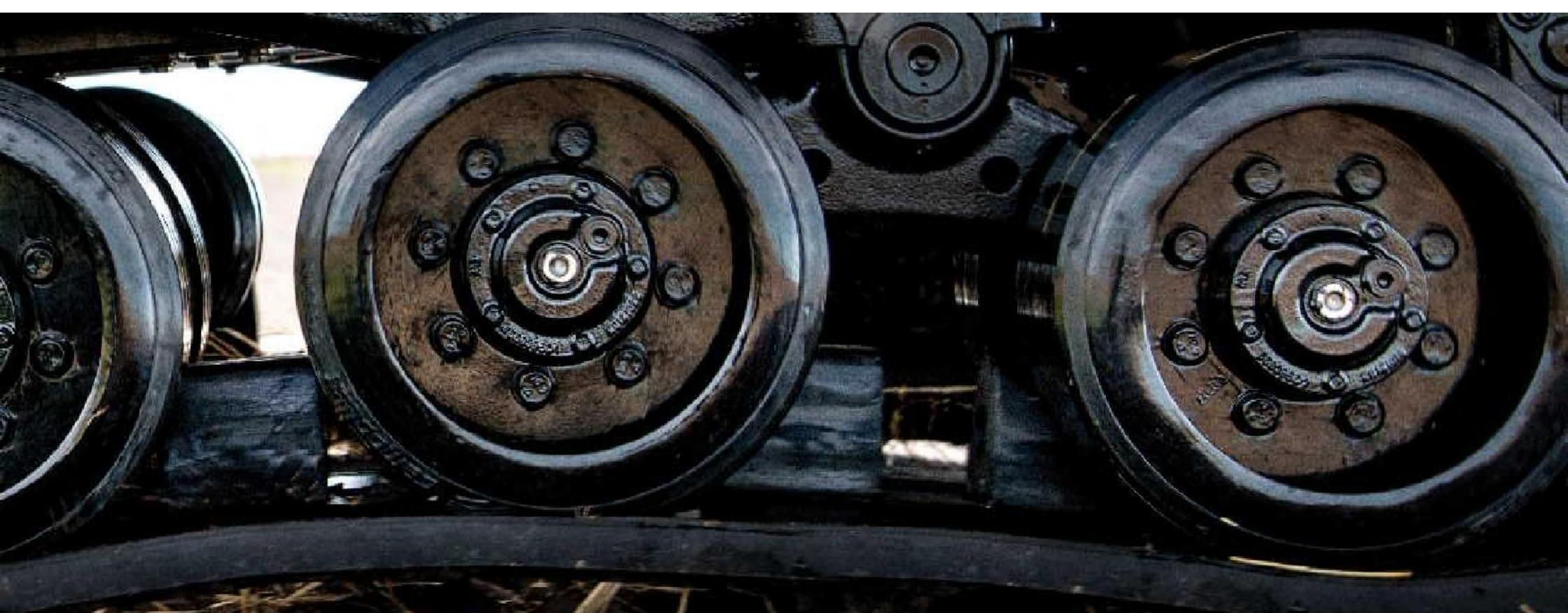
Pero aquí hay mucho más en juego que simplemente potencia bruta. El confort resulta fundamental cuando se trata de un largo día de trabajo en el campo. El sistema Mobil-trac proporciona el andar más confortable gracias al sistema de resortes *MarshMellow* que se comprimen y expanden permitiendo que la barra torsión oscile con libertad. Esta reducción de vibración proporciona una conducción mucho más cómoda que los sistemas de suspensión por air-bag de la competencia.
