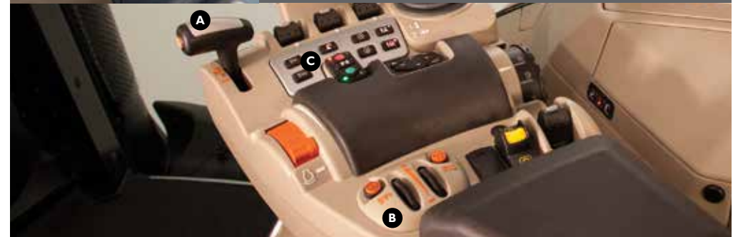
A. Palanca Dyna VT. B. Memorias de velocidades de SV1/SV2, modo de funcionamiento de Dyna-VT y selección de gama. C. Acoplamiento de SV1/SV2.
