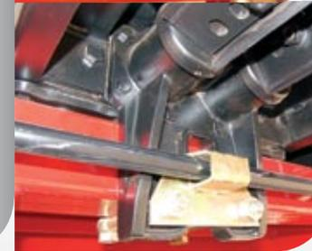
Opcional de fundición nodular o aluminio, con engranajes cónicos. Su nuevo diseño agiliza el desplazamiento de las unidades de surco en el proceso de conversión
