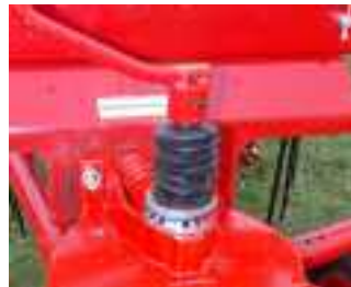
Regulación de altura de barrido Height adjustment of the sweep
