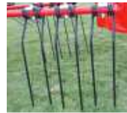
3 puas dobles de acero por brazo. 3 double steel tines per arm
