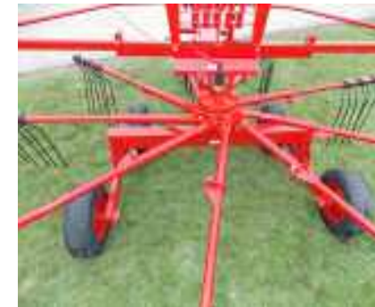
3 puas dobles de acero por brazo. 3 double steel tines per arm
