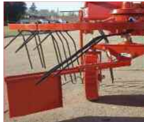
Ruedas de apoyo que determinan altura de trabajo y brazo para delimitar la hilera de los podos
