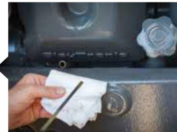
El diseño del eje delantero y el capó estilizado garantiza un acceso cómodo a los filtros de aceite del motor y a la varilla indicadora del nivel de aceite.
